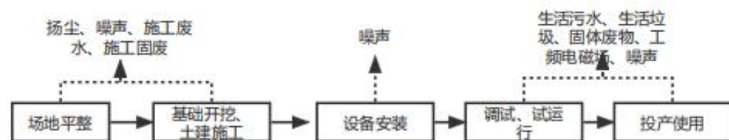
图 2-5 升压站施工工艺流程及产污节点图
